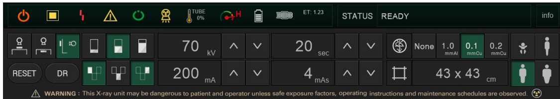
Botão de tamanho do paciente ativado (FGXR com Colimador Motorizado)
