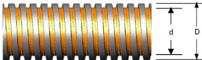
Figura 47- Detalhe do tubo dreno corrugado em PEAD.
