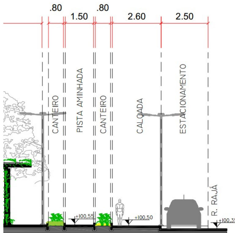
Figura 14: Detalhe Pista de Caminhada e Calçada de Serviço
